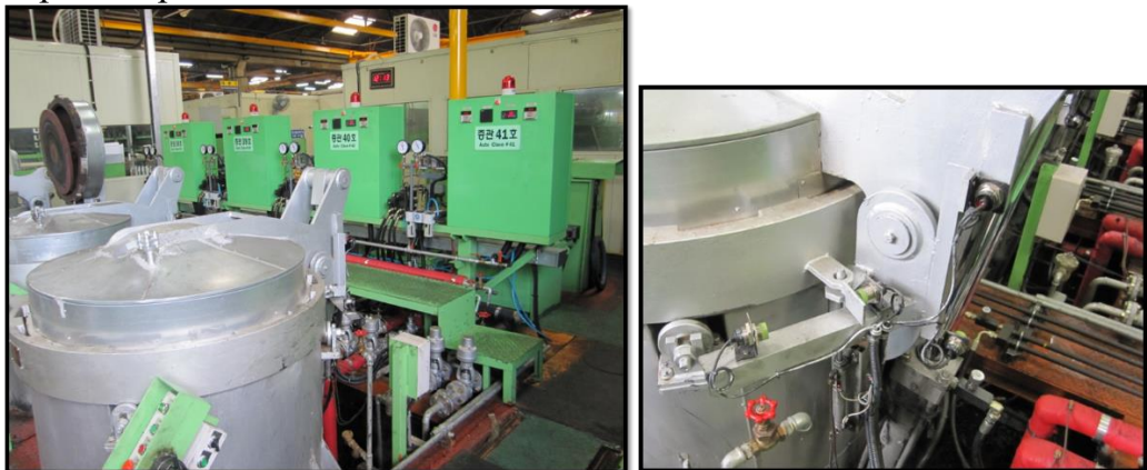
Рис.4.8 – Контроль крайних состояний крышки бака (открыто или закрыто)
