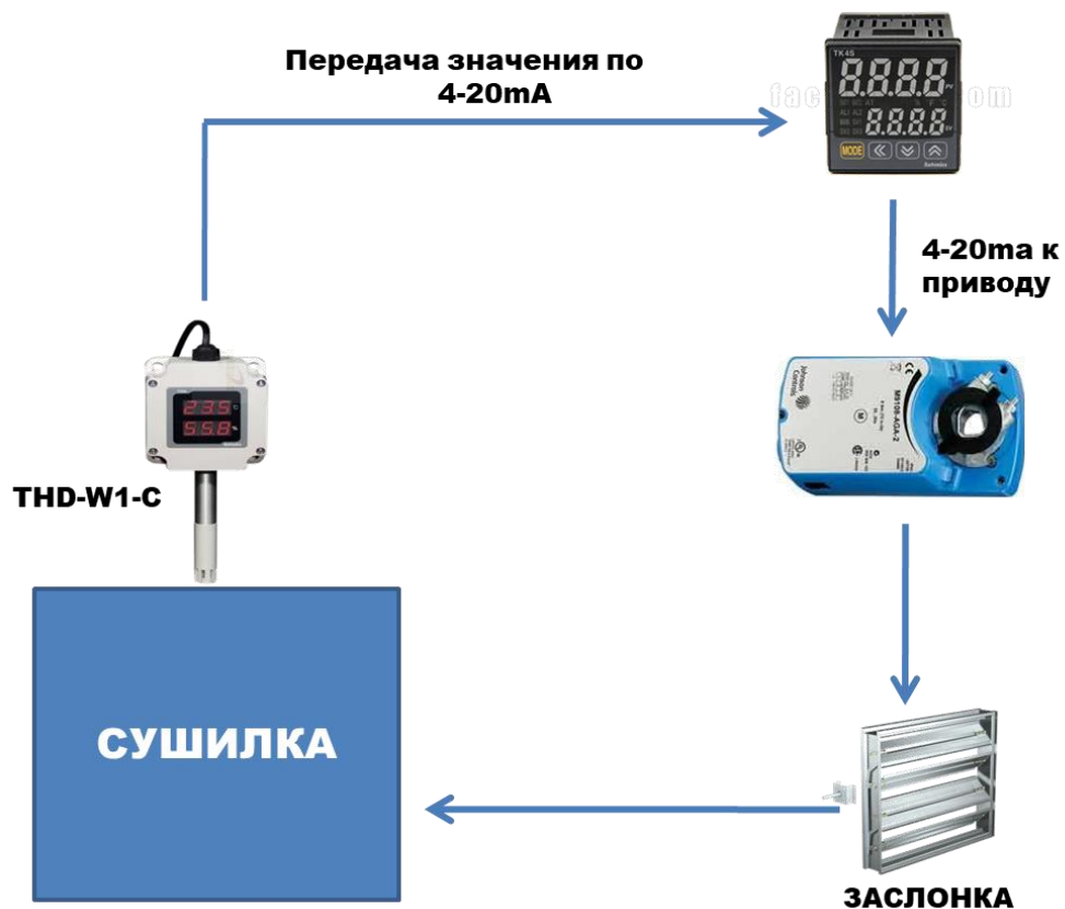
Рис. 4.14 – Схема контроля температуры и влажности сушилки
